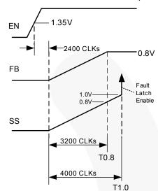
Figure 21. Soft-Start Timing Diagram
